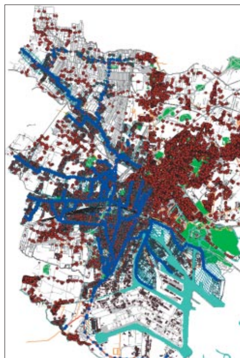
Fig.5: MODELLO NUMERICO DELLA RETE FOGNARIA DELL'AMBITO DI FUSINA (VE)
