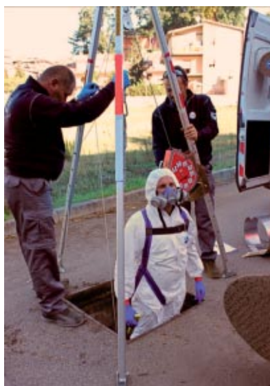
Fig.4: CAMPAGNA DI MISURA DELLE PORTATE IN FOGNATURA
