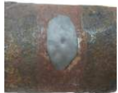
Bi-componente epossidico sigillante putty
