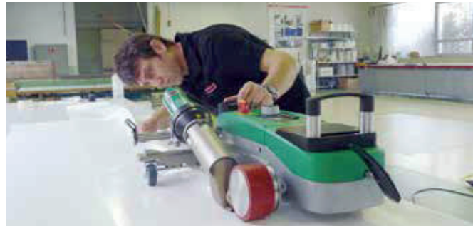
Facile saldatura di orlatura e rinforzo con l'apposito kit.
