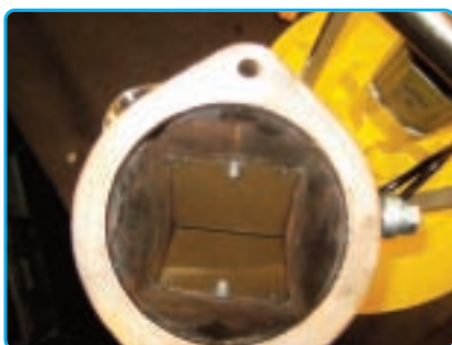
Immagine della bocca di scarico con le finestre chiuse
