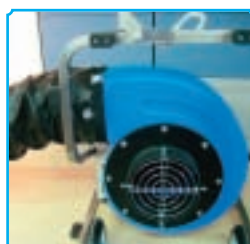
Dettaglio del sistema di installazione rapida delle manichette
