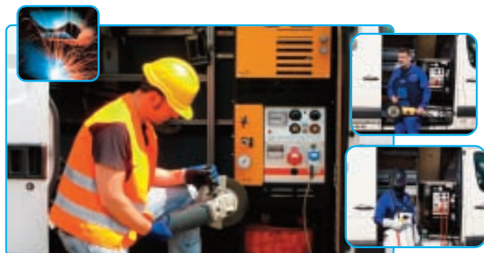
Utilizzo elettrico tri-mono fase e saldatura
