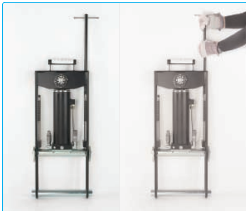
Chiave a "T" lunga per il bloccaggio meccanico di sicurezza quando il tubo è in schiacciamento.
