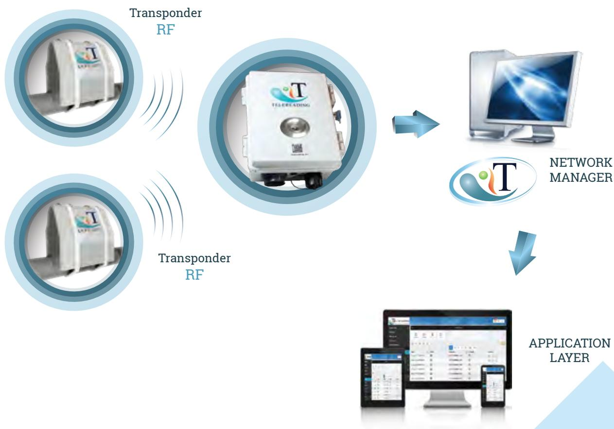
I dati rilevati sul campo sono inviati su base pianificata ad un concentratore fisso che provvederà successivamente a trasmetterli al sistema di acquisizione centrale.
