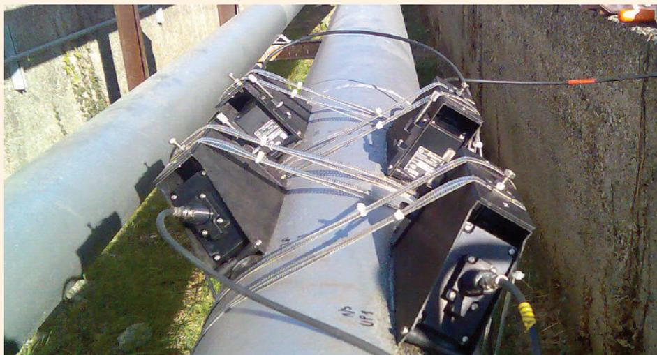
L'applicazione dei trasduttori Clap-on a doppio fascio di ultrasuoni
