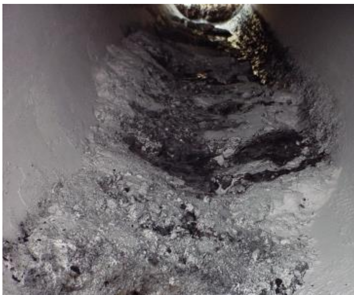
Depositi di sale indurite sedimentati a monte di una curva Stampata.
