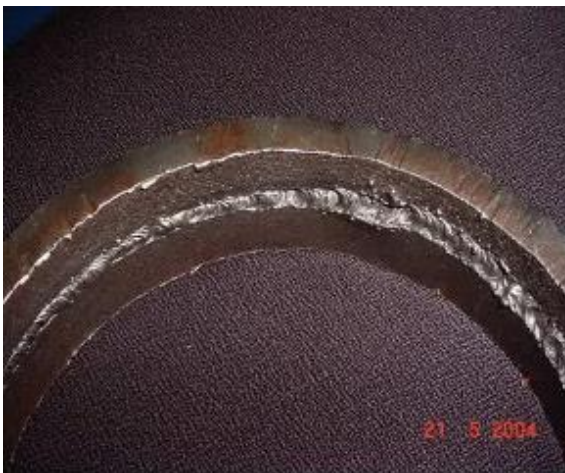
Eccesso di penetrazione
