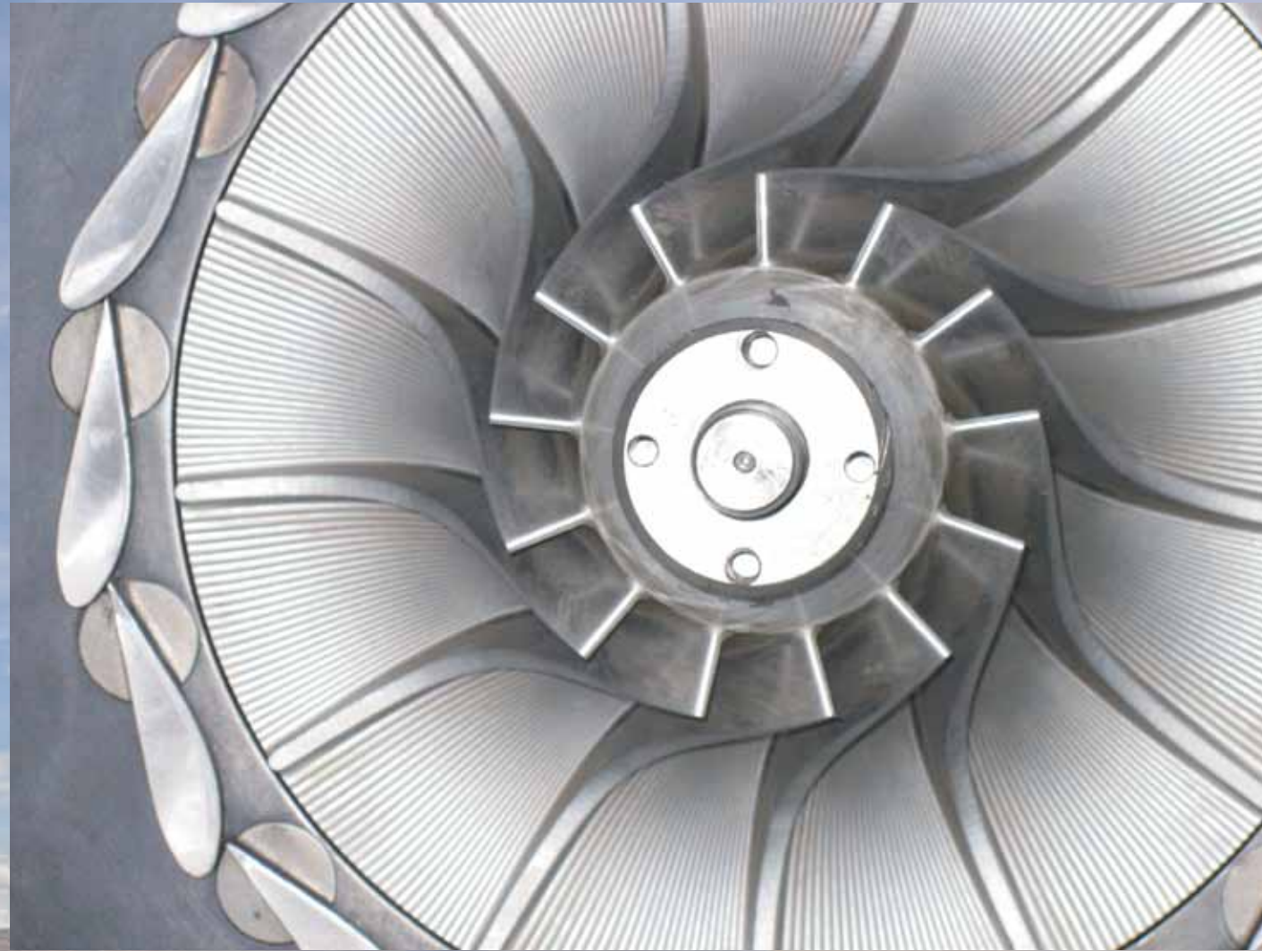
Girante di un turboespansore Wheel of a turboexpander
