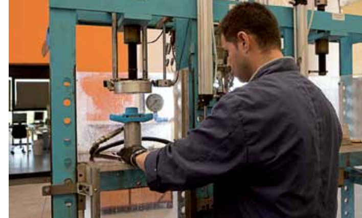
collaudo collari di presa | saddle testing
