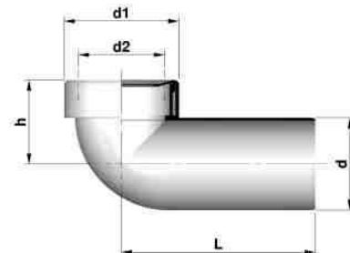
**Curva W.C. a 90° bianca completa di guarnizione HTSB**
