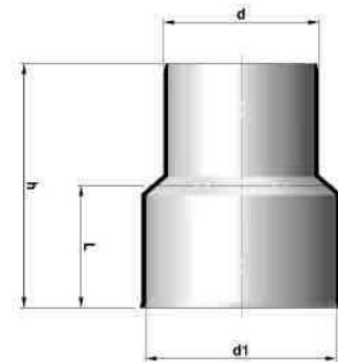
**Raccordo per giunzione con tubi in ghisa con doppia guarnizione HTUG**
