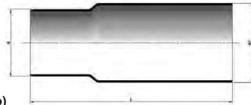
**Raccordo in PVC per il collegamento con tubi PP (ad incollaggio)**
