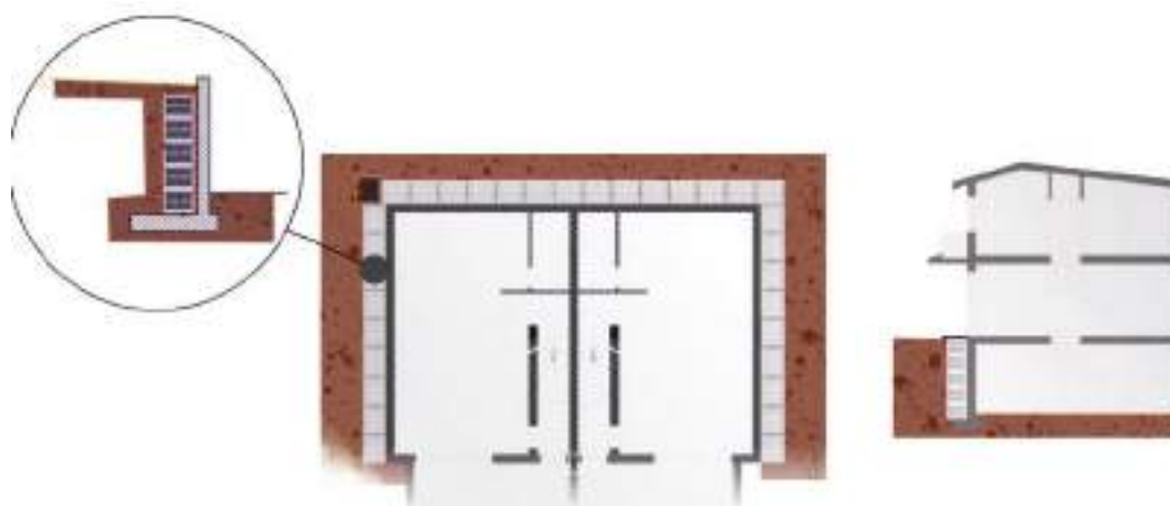
Schema di vasca di ritenuta per acque meteoriche con cameretta di testata per ispezione e sedimentazione
