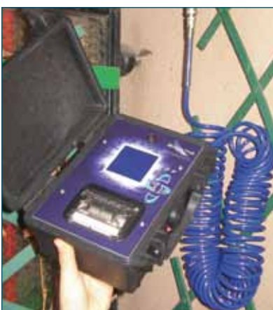
Verifica in pressione con pompa interna
