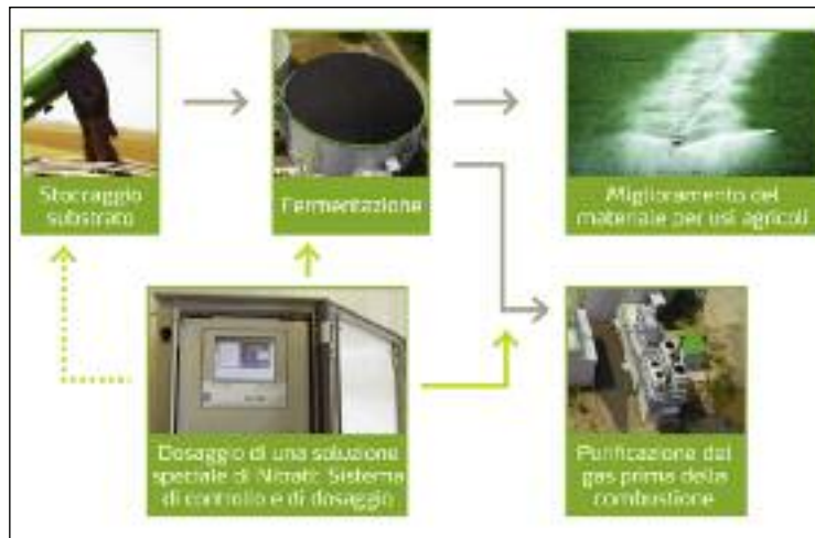
Le possibilità di ottimizzazione nella produzione di biogas con il dosaggio di una soluzione speciale di nitrato
