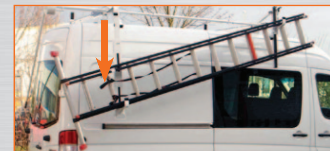
La versione di ErgoRack per tetti alti utilizza una estensione per abbassare la scala alla corretta altezza ergonomica rispetto all'operatore che esegue il carico/scarico.
