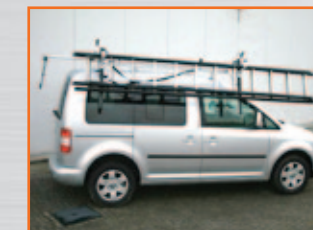
ErgoRack a rotazione (per scale <35 kg)
