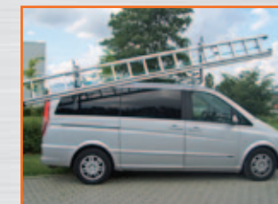
ErgoRack a inclinazione (per scale <55 kg)
