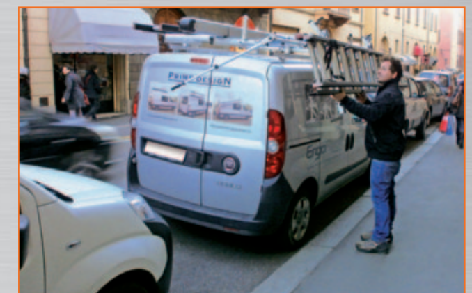
In parcheggi limitati o ristretti, soprattutto posteriormente, Ergorack è la soluzione ideale per il carico/scarico di scale perché si manovra dai lati.
